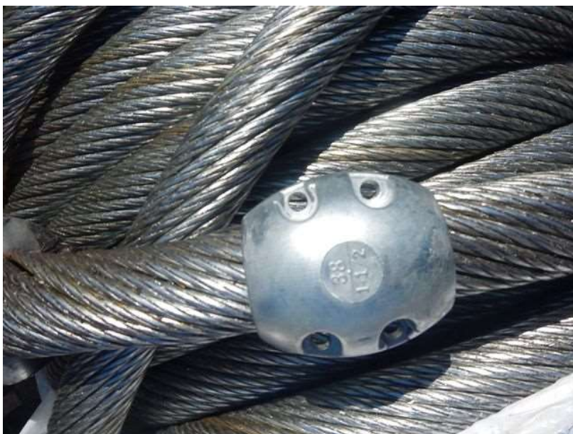
Anodo di zinco fissato lungo le funi in acciaio Ø 38 mm – ormai consumati del tutto
