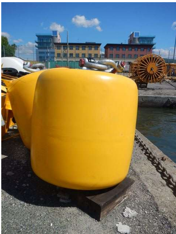
Jumpers prima della posa in opera - Altezza 1.150 mm - Diametro 1.150 mm
