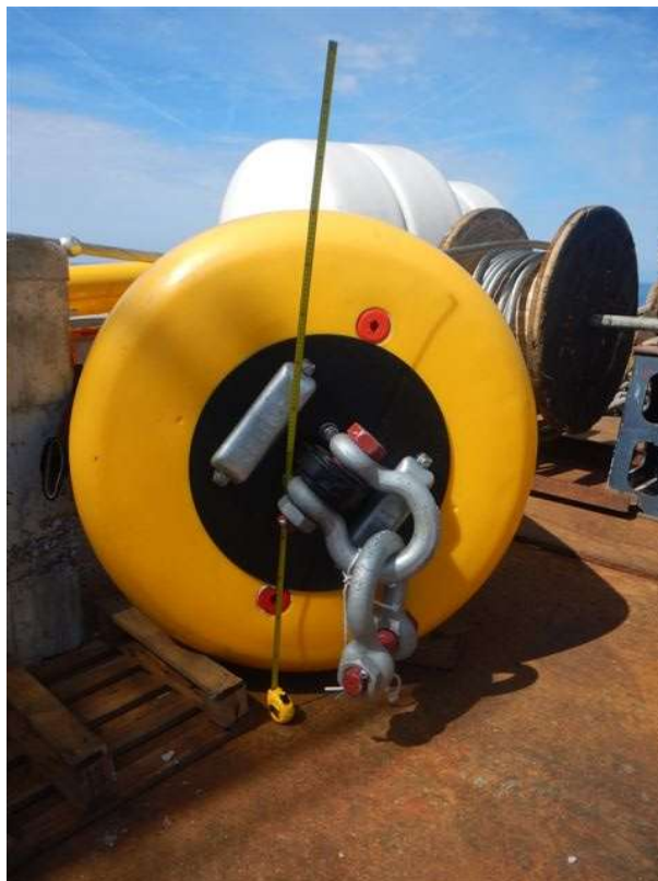
Jumpers prima della posa in opera - Altezza 1.150 mm - Diametro 1.150 mm
