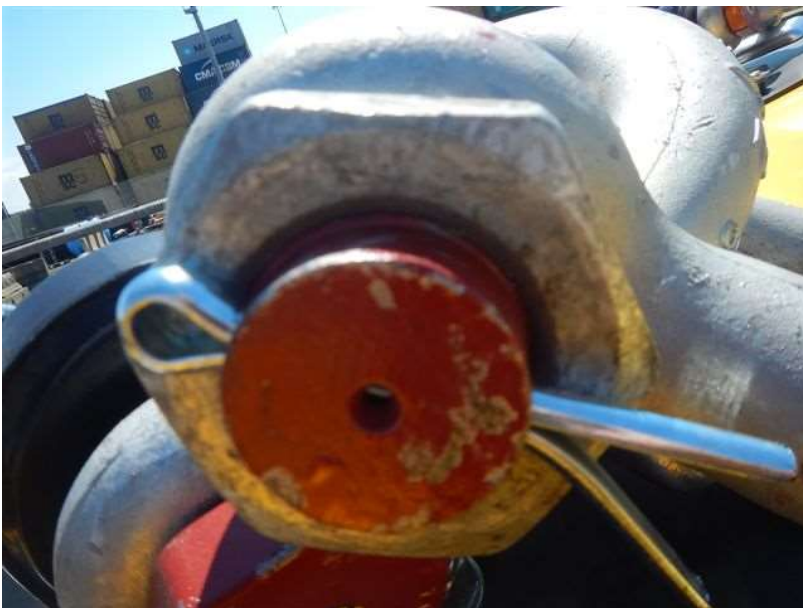
Particolare di una coppia di fermo del perno dei maniglioni
