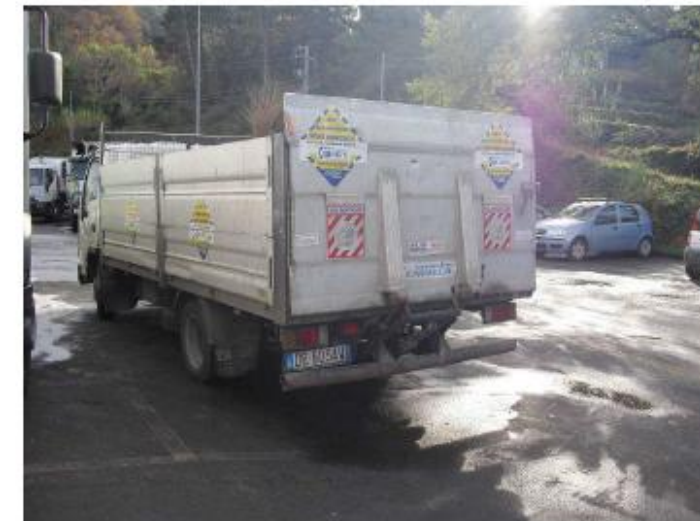
Figura 15: esempio di mezzo con pianale munito di sponda idraulica
